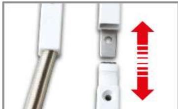
Der Stecker und die Buchse dürfen maximal 10-mal gesteckt werden, da die Beschichtung der Pins mit jedem Stecken abgetragen wird.
