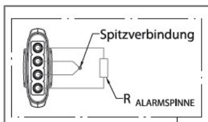
Die beiden mittleren Kontakte der Buchse des Alarmglases überbrücken und mittels Widerstandsmessgerät die Spitzverbindung zwischen den 2 verbleibenden Adern ermitteln und markieren (z.B. Verdrillen).
