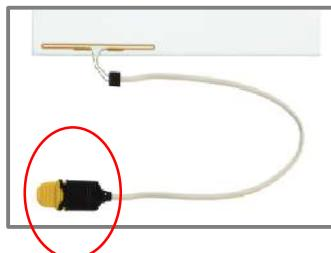
Die Alarmglasanschlussbuchse darf bei der Bestimmung der Adernzugehörigkeit nicht gesteckt werden, da die Widerstände ansonsten nahezu identisch sind.
