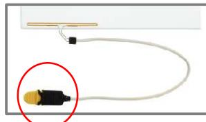
Die Buchse des Alarmglases darf bei der Bestimmung der Adernzugehörigkeit nicht gesteckt werden, da die Widerstände ansonsten nahezu identisch sind.
