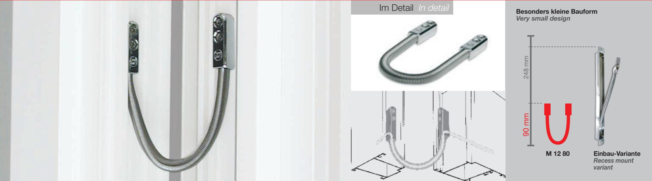
Der Miniatur-Kabelübergang eignet sich aufgrund seiner geringen Baugröße für den verdeckt liegenden Einbau in Tür- und Fensterfalte. Die Dreh- und Kippfunktion behält dabei ihre volle Funktionalität. Der Montageaufwand ist denkbar einfach, denn durch den geringen Platzbedarf ist der Einbau im Falzbereich fast überall möglich. Der Miniatur-Kabelübergang eignet sich sowohl für Sensorenleitungen als auch für Alarmglasleitungen.
